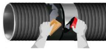
Нанести эпоксидную смесь ровным слоем толщиной не менее 100 - 150 мкм на всю поверхность металла и на 10 мм прилегающего покрытия трубы. Эпоксидная смесь - легковоспламеняющееся вещество, поэтому необходимо принять все необходимые меры предосторожности и безопасности при его применении.
