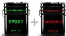
Смешать «Ероху» часть А-основа и «Hardener» часть В-отвердитель. Перемешивать не менее 1-3 минут до получения однородной смеси. Время жизни эпоксидной смолы после смешивания составляет 45 мин. при температуре +23°C (+73°F) и 15 мин. при температуре +40°C (+104°F).
