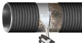
Произвести пескоструйную обработку металлической поверхности. В результате очистки состояние поверхности должно быть Sa 2.5 («белый металл»). После завершения пескоструйной очистки поверхность следует оберегать от попадания на нее пыли и влаги.
