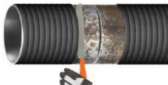
Обеспечить скос краёв заводской изоляции под углом 30°. Заводскую изоляцию обработать по окружности крупной наждачной шкуркой до образования шероховатости. Удалить шлифовальную пыль.
