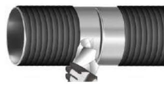
С помощью сухой ветоши протереть стальную поверхность и участки с заводским покрытием или обдуть воздухом для удаления инородных материалов.
