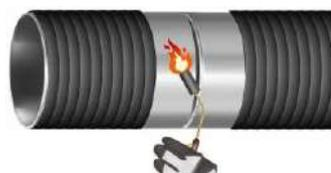
Зону вокруг сварного стыка и прилегающее заводское покрытие подогреть до температуры 80-90°C (176-194°F), но не более 100°C (212°F).
