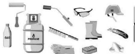
Оборудование и инструменты для абразивной очистки поверхности. Баллон с пропаном, шланг, горелка, регулятор. Губка для нанесения эпоксидной смолы, нож, ветошь, растворитель, цифровой термометр (пирометр). Стандартные средства индивидуальной защиты (защитная обувь, каска, защитные очки, перчатки) в соответствии с местными нормами по охране труда и здоровья. **Персоналу, не имеющему опыта нанесения термоусаживающихся манжет, настоятельно рекомендуется пройти обучение.**
