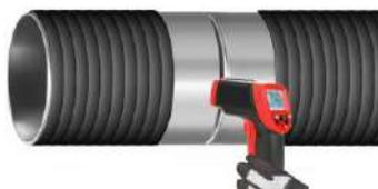
Температуру нагрева стыка в разных точках контролируют пирометром, чтобы убедиться, что труба нагрета по всей окружности.
