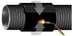
С помощью горелки соответствующей мощности нагревать трубу от центра манжеты по окружности широкими проходами. При использовании двух горелок, операторы должны работать на противоположных сторонах трубы.
