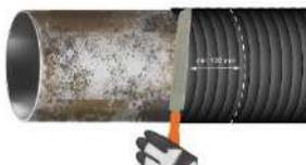
Coupez les bords de l'isolation d'usine à un angle de 30 °. Poncez l'isolant d'usine autour de la circonférence avec du papier de verre grossier jusqu'à ce qu'il soit rendu rugueux - une zone égale à deux fois la largeur du ruban. Retirez la poussière de ponçage.
