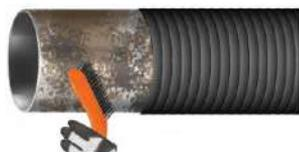
Avant d'appliquer le système anticorrosion, la surface du tuyau et l'isolation d'usine adjacente doivent être exemptes de rouille, de poussière, de saleté, de peinture, de restes d'isolant ancien et endommagé, de taches d'huile (si nécessaire, utilisez un solvant approprié). S'il y a de l'humidité en surface, séchez-les avec un brûleur à gaz (propane).
