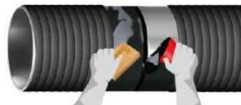
Appliquer le mélange époxy en une couche uniforme d'une épaisseur d'au moins 100 à 150 microns sur toute la surface métallique et sur 10 mm du revêtement de tuyau adjacent.
