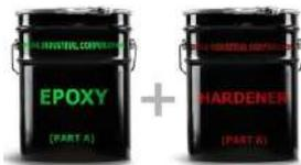
Mélanger la base époxy partie A et le durcisseur partie B durcisseur. Remuer pendant au moins 1 à 3 minutes jusqu'à ce qu'un mélange homogène soit obtenu. La durée de vie en pot de l'époxy après mélange est de 45 minutes. à une température de + 23 ° C (+ 73 ° F) et 15 min. à une température de + 40 ° C (+ 104 ° F).
